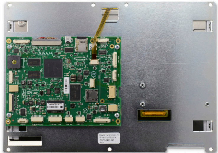
10.1" G2H2-10R Display Module, back view
